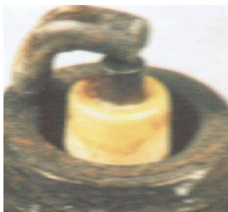
Glasagtig gult lag: Karburator eller tænding fejljusteret
