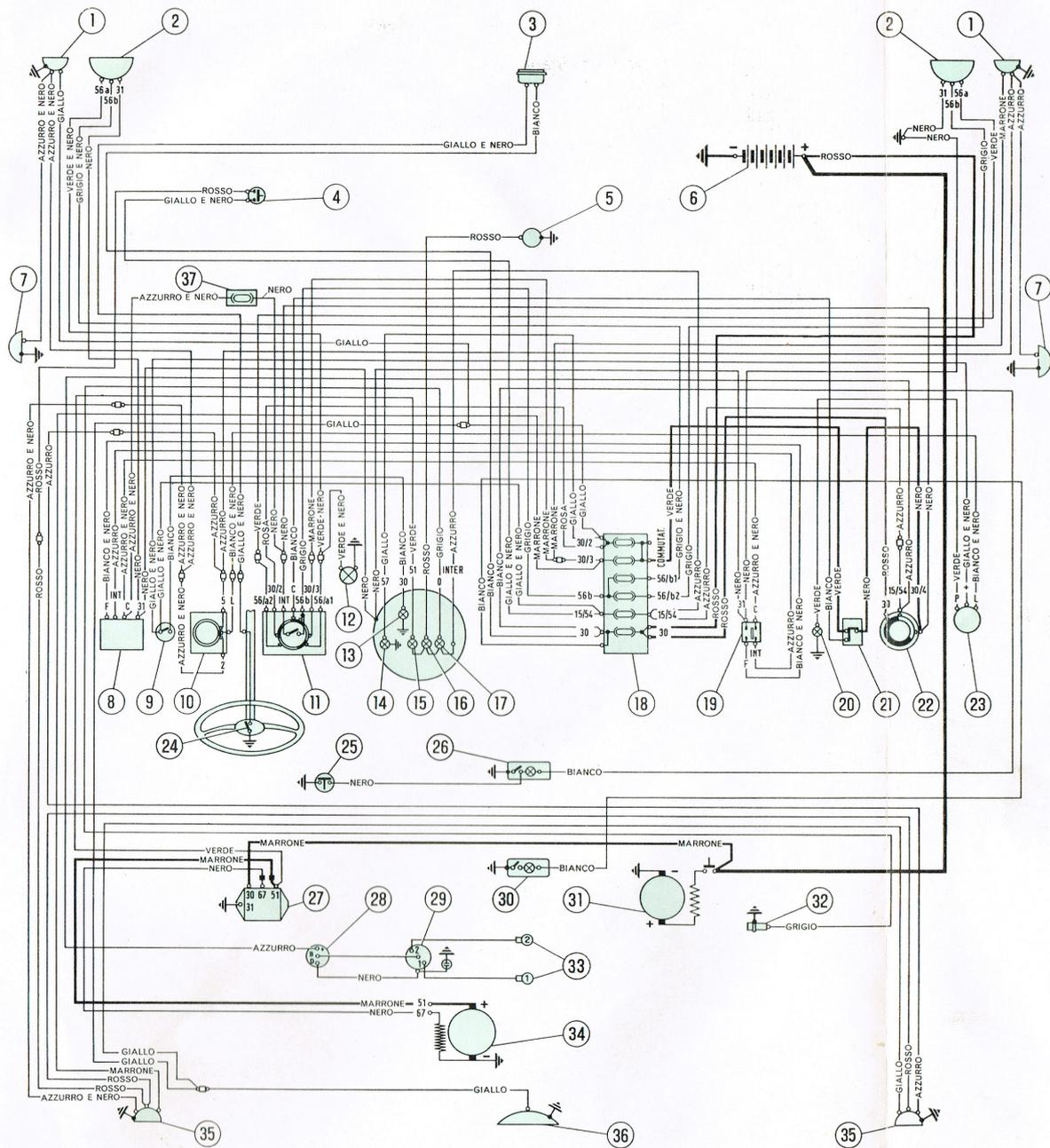
**Schaltplan der elektrischen Anlage.**
