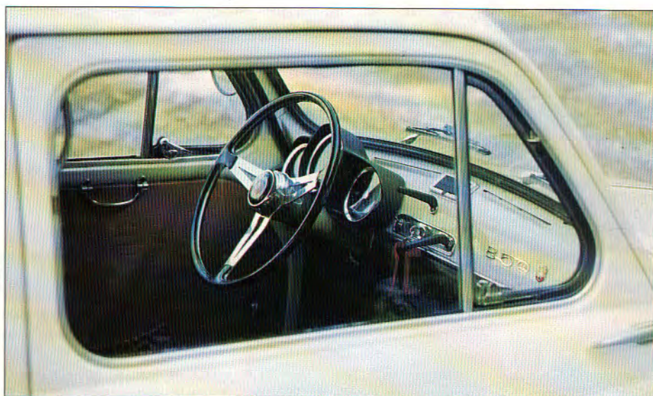
Qui sopra: la plancia col quadro strumenti e il volante speciale a tre razze appositamente realizzati dall'Abarth. Lo strumento di bordo combinato comprende il contagiri (al centro), il contachilometri totale e parziale e il tachimetro (a destra) e gli indicatori benzina, acqua ed olio (a sinistra); vi sono inoltre le spie dell'olio e della dinamo.
