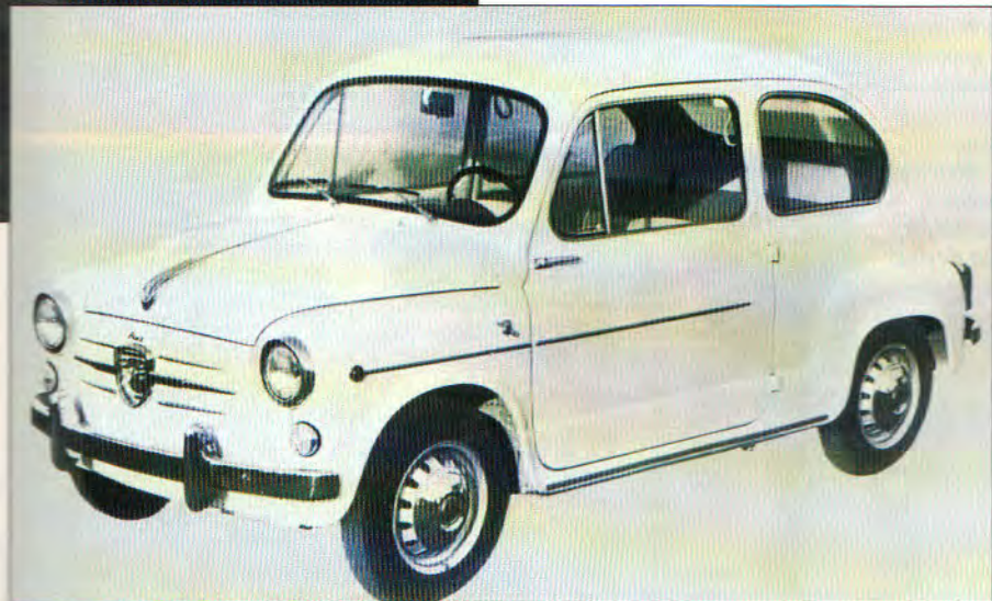
Qui sopra: vista d'insieme della 850 TC; da notare le ruote con i cerchi autoventilanti e le borchie portanti il marchio circolare dello Scorpione. A destra: una pubblicità del 1962 che evidenziava l'adozione dei freni a disco anteriori.
