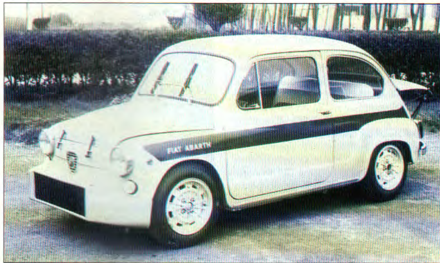
Dal 1966 in poi le Fiat-Abarth 850 TC e 1000 Berlina adottano la carrozzeria dell'ultima Fiat 600 D; da notare il radiatore acqua-olio con carenatura più aerodinamica e la caratteristica fascia laterale con la sola scritta "Fiat Abarth".
