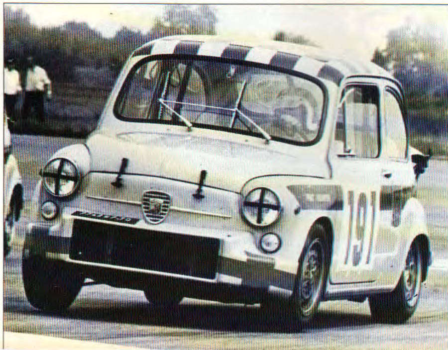
Dal 1966 in poi le Fiat-Abarth 850 TC e 1000 Berlina adottano la carrozzeria dell'ultima Fiat 600 D; da notare il radiatore acqua-olio con carenatura più aerodinamica e la caratteristica fascia laterale con la sola scritta "Fiat Abarth".
