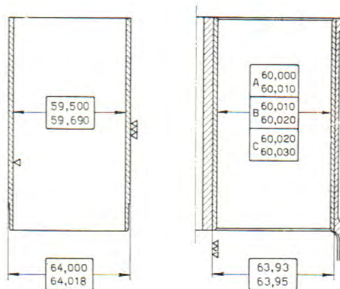
Fig. 3. Indv. og udv. diameter på foringer før samling (i.v.).
