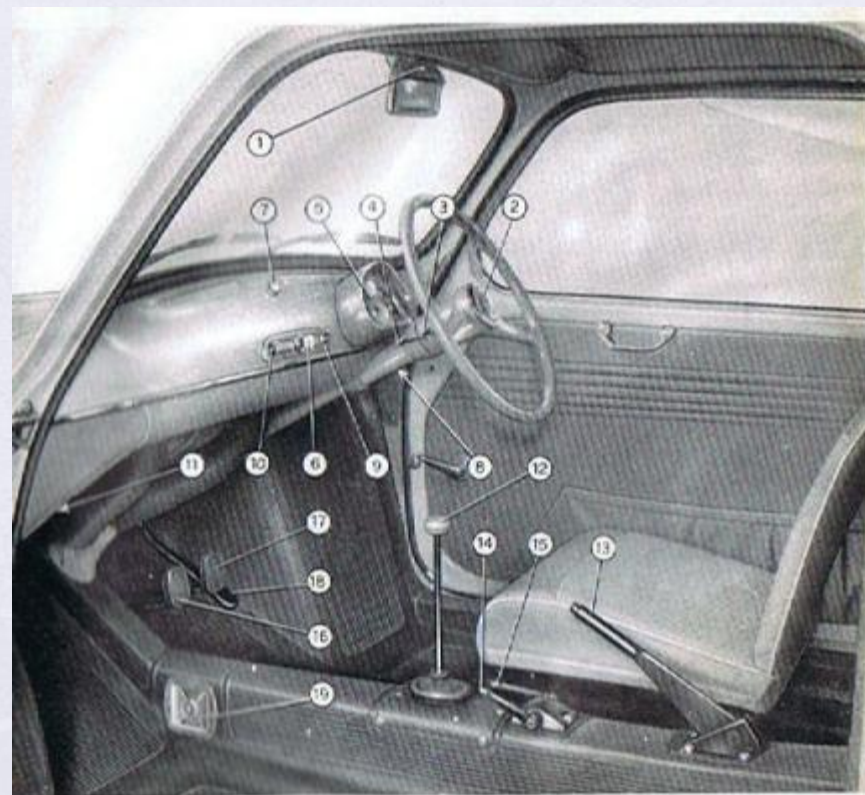
Fig. 14 B. Betjenings- og kontrolorganer (højrestyring).
