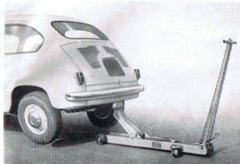
Fig. 54: Bagenden af vognen løftet med rullede donkraft.
