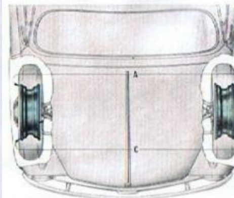
Fig. 45: Kontrol af toe-in (forhjulenes spidning) og camber (forhjulenes hældning udefter) med fuldtlastet vogn.
